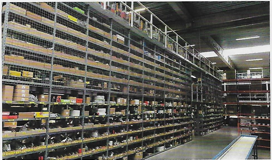
Minder courante stukken plaatst Best Parts op de mezzanines. Naarmate de rotatiesnelheid afneemt, krijgt het stuk een hoger gelegen plek.
